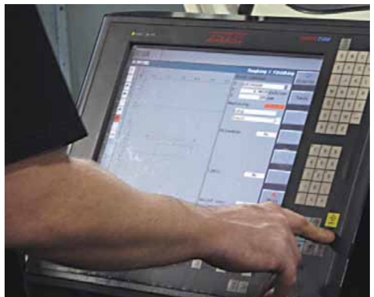
Close up of Siemens Sinumerik 840D sl
