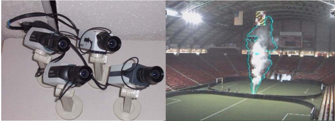
Figure 11. SigniFire VID System
